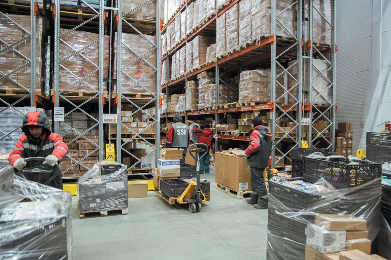
Технология «мобильных стеллажей» позволяет увеличить плотность хранения на 1 кв. м до 4-4,5 паллетомест вместо стандартных 1,8-2
